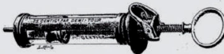
Seringue du Dr. Olivier de 1895. Elle a une contenance de 20ml, et possède un système permettant de débrayer le pas de vis et de transformer le mouvement rotatif en une translation continue (facilitant le remplissage de la seringue).
