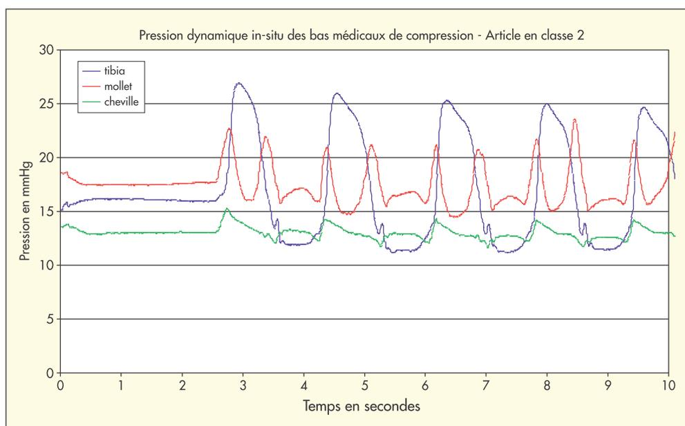
Fig. 12. – Pression dynamique des bas médicaux de compression in situ
