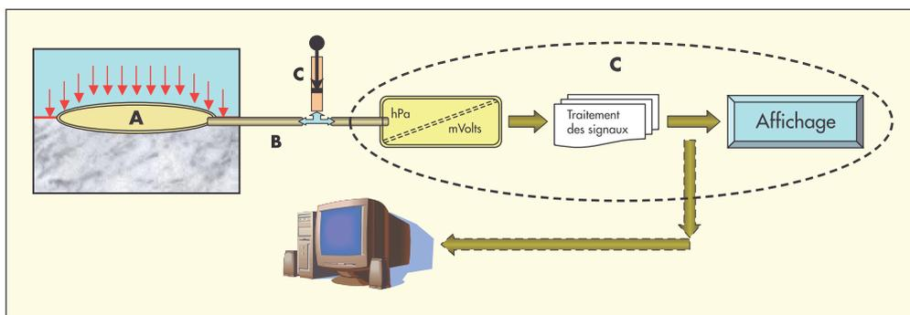
Fig. 8. – Principe SIGaT de mesure de pression d'interface
