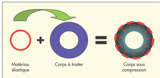
Fig. 1. – Principe de la compression élastique
