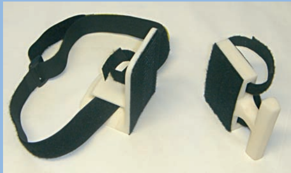
FIGURE 1 : Dispositif porte-sonde échographique ultrasonore.
