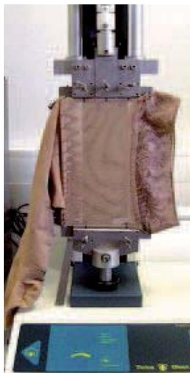
FIGURE 2 : Méthode de mesure de la pression *in vitro* par dynamométrie.
