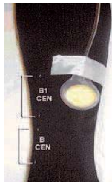
FIGURE 3 : Marquage des chaussettes au point B1 CEN. (les marques correspondent aux points de mesures dynamométriques in vitro : B en bas et B1 en haut.
