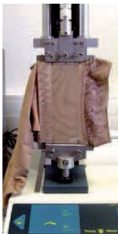
FIGURE 2 : Méthode de mesure de la pression in vitro par dynamométrie.
