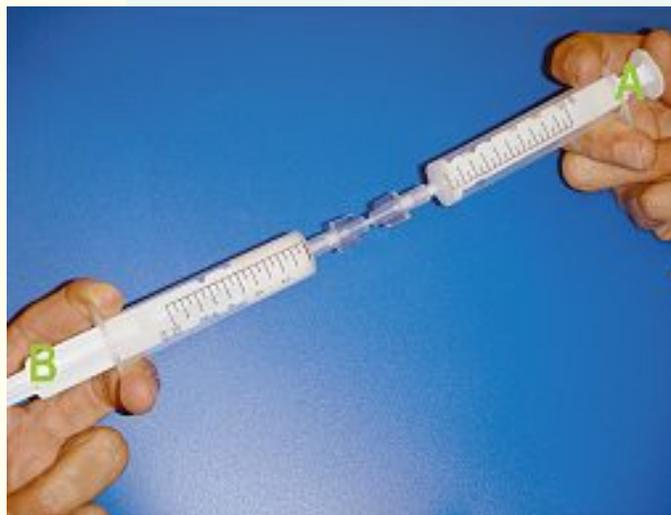
Lorsque le pouce de la main gauche pousse le piston de la seringue B vers la droite, le pouce de la main droite retient le piston de la seringue A. Ce qui a pour effet d'augmenter la pression dans les seringues et d'augmenter la turbulence (**Figure 2**).
