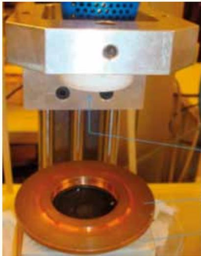
Échantillon et joint positionnés dans le disque de maintien, au-dessus du cylindre sur lequel est déposée la goutte d'eau calibrée.
