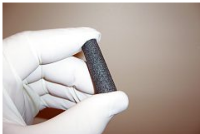
Fig. 2. – Abrasif enroulé sur un coton dentaire
