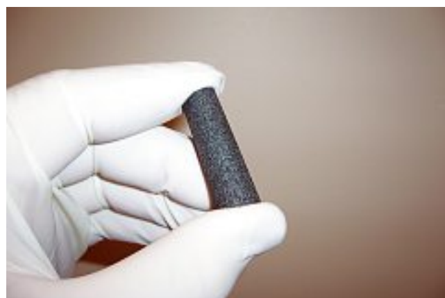
Fig. 2. – Abrasif enroulé sur un coton dentaire
