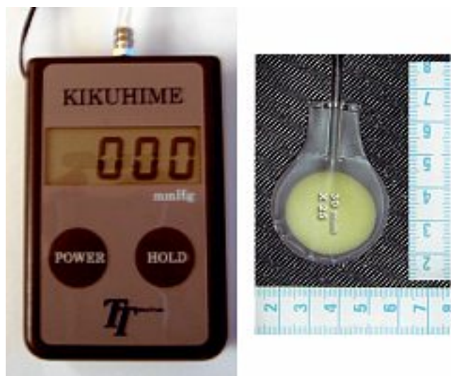
Photo 1. – Système de mesure Kikuhime®
