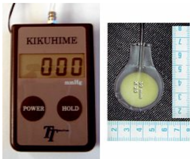
Photo 1. – Système de mesure Kikuhime®
