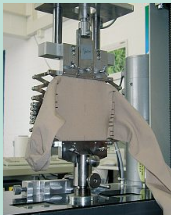
FIGURE 8 : Dynamomètre, instrument permettant d'obtenir la courbe caractéristique des matériaux \text{force} = f(\text{allongement}) .
