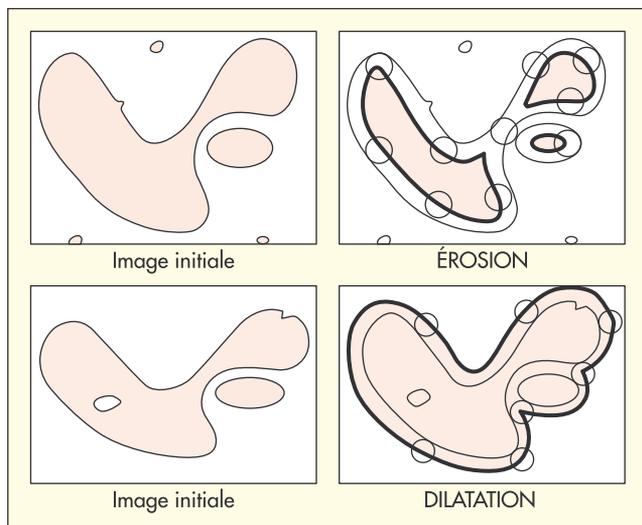
Fig. 5. – Les opérateurs morphologiques : érosion et dilatation
