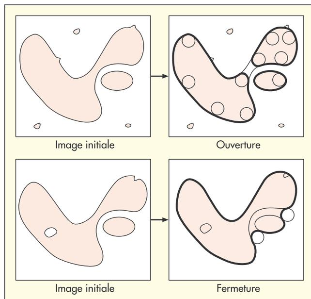
Fig. 6. – Les opérateurs morphologiques : ouverture et fermeture
