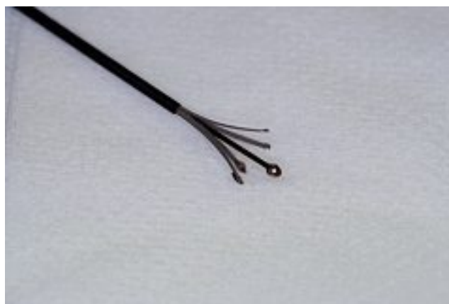
Photo 4. – Sonde de radiofréquence (technique Closure®)
