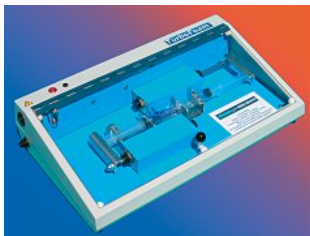
Photo 5. – Turbofoam® Machine pour la fabrication automatisée de mousse
