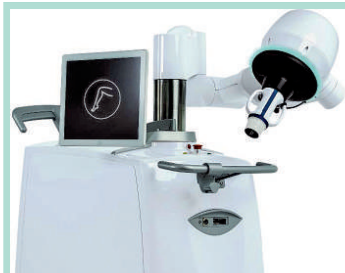
FIGURE 8 : SONOVEIN® (Théraclion) traitement par échothérapie des varices.
