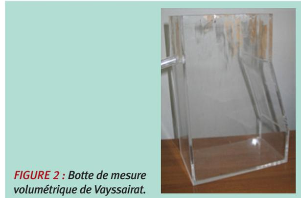
**FIGURE 2 :** Botte de mesure volumétrique de Vayssairat.
