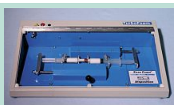
FIGURE 6 : Machine standardisant le va-et-vient pour la fabrication de la mousse, 2004
