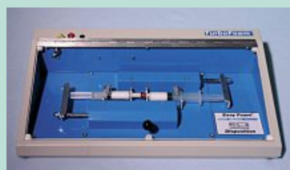
FIGURE 6 : Machine standardisant le va-et-vient pour la fabrication de la mousse, 2004
