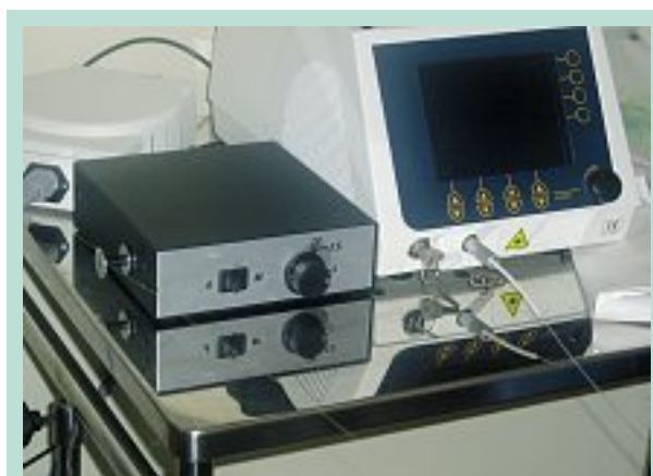
FIGURE 10 : Mini treuil électrique pour le retrait continu et motorisé d'une fibre laser, 2004.
