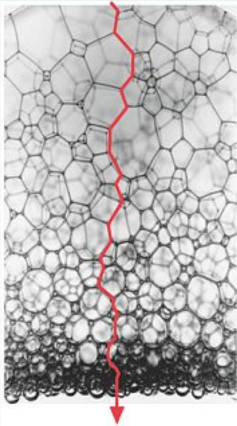
**FIGURE 4 :** Écoulement du liquide à travers la mousse sous l'effet de la gravité : les bulles du haut deviennent polyédriques et sèches, alors que celles du bas deviennent plus humides et sphériques.
