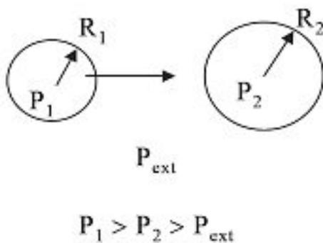
**FIGURE 5 :** Le mûrissement est lié à la différence de pression entre deux bulles de diamètre différent : l'air contenu dans la bulle la plus grande où la pression est plus faible selon les lois de Laplace. La mousse perd peu à peu de son homogénéité et la mousse devient beaucoup moins stable.
