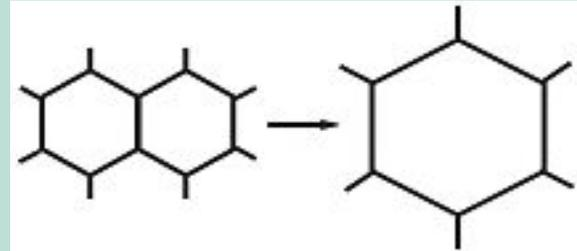
**FIGURE 6 :** La rupture d'un film de surface séparant deux bulles réalise une bulle de plus grande taille et marque le début d'un phénomène en cascade, véritable avalanche qui précipite la lyse de la mousse.
