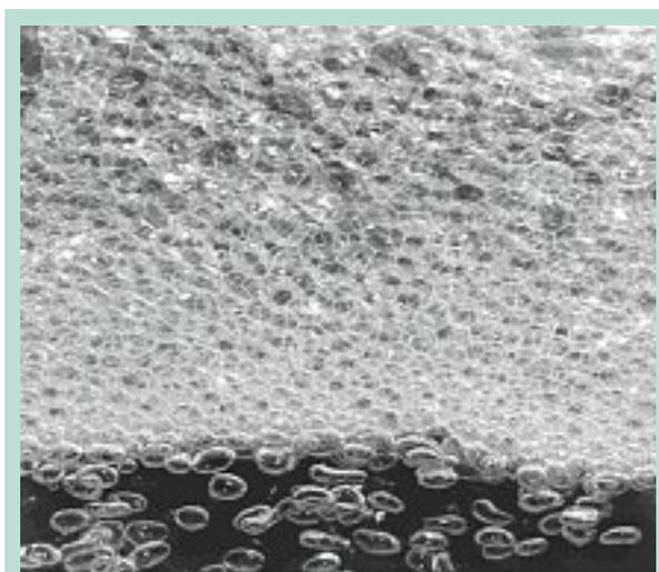
**FIGURE 1 :** Aspect d'une mousse et ses 2 stades de structure : en bas, bulles d'air dans le liquide, au centre, bulles humides circulaires, avec des films liquides épais ; en haut, bulles polyédriques plus sèches, aux films liquides minces.
