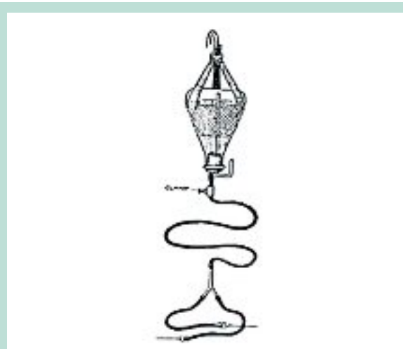
FIGURE 4 : Remplissage par gravité ressemblant au système « pieuvre ».
