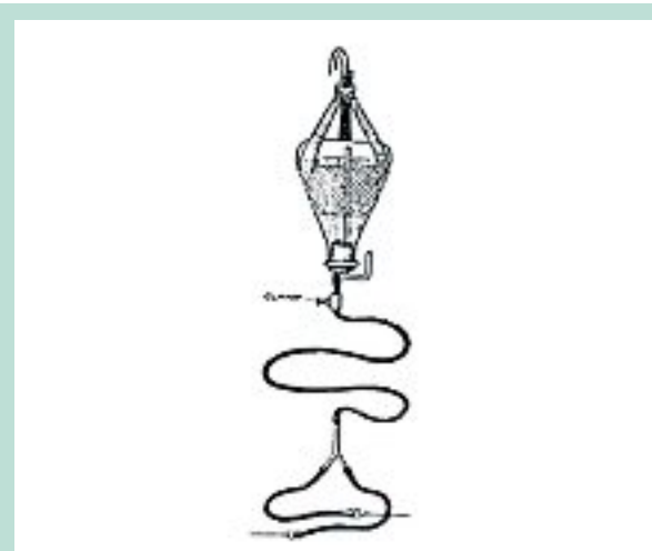
FIGURE 4 : Remplissage par gravité ressemblant au système « pieuvre ».
