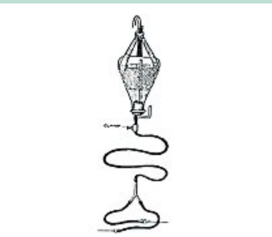
FIGURE 4 : Remplissage par gravité ressemblant au système « pieuvre ».
