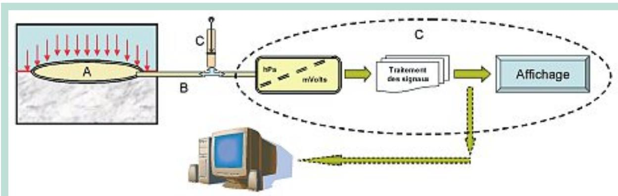
**FIGURE 9 :** Principe de mesure de pression d'interface in-situ.
