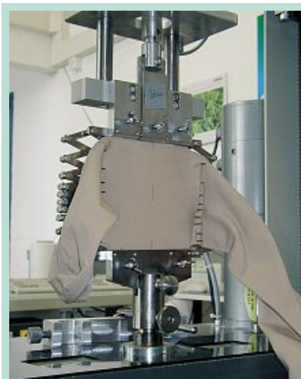
FIGURE 8 : Dynamomètre, instrument permettant d'obtenir la courbe caractéristique des matériaux force = f(\text{allongement}) .
