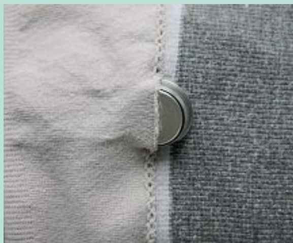
FIGURE 1 : Capteur thermique (Thermotrack®) dans le revers d'une chaussette. J.-P. Benigni.
