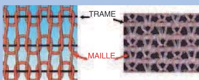
FIGURE 2 : Maille et trame d'un bas de compression.
