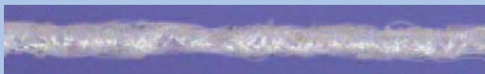
Photographie d'un fil guipé double couverture.
