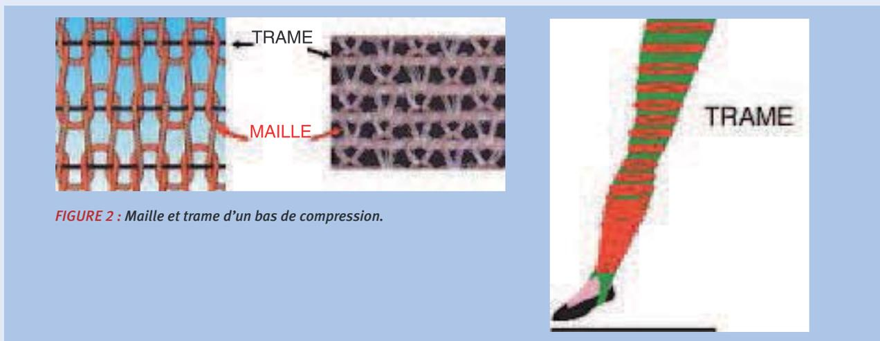
FIGURE 2 : Maille et trame d'un bas de compression.
