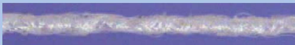
Photographie d'un fil guipé double couverture.
