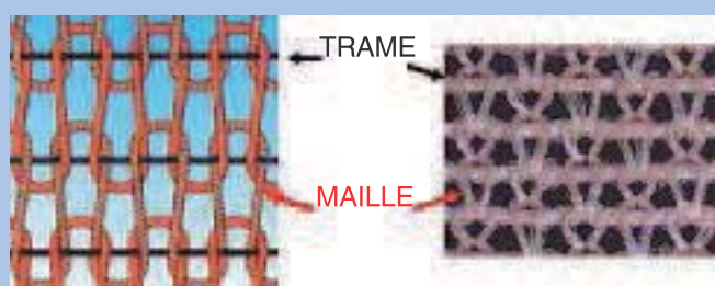
FIGURE 2 : Maille et trame d'un bas de compression.
