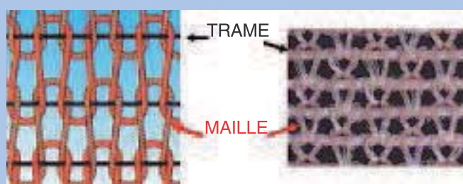
FIGURE 2 : Maille et trame d'un bas de compression.
