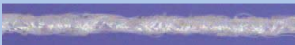
Photographie d'un fil guipé double couverture.
