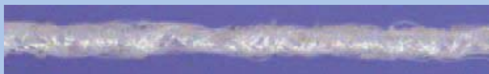
Photographie d'un fil guipé double couverture.
