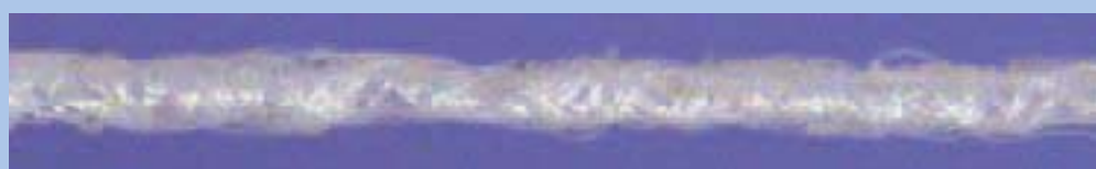
Photographie d'un fil guipé double couverture.
