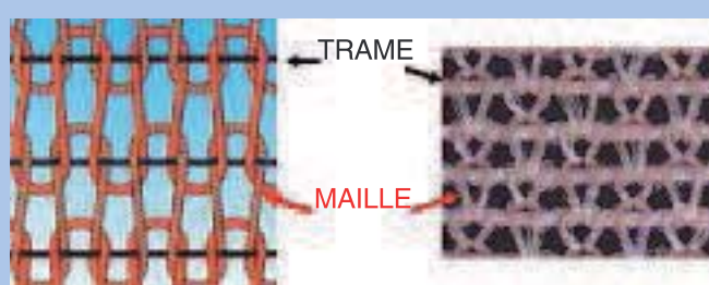
FIGURE 2 : Maille et trame d'un bas de compression.
