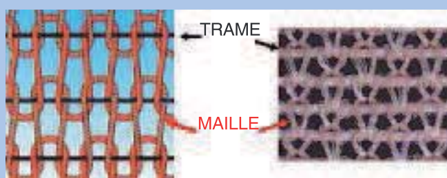
FIGURE 2 : Maille et trame d'un bas de compression.
