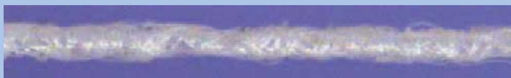
Photographie d'un fil guipé double couverture.
