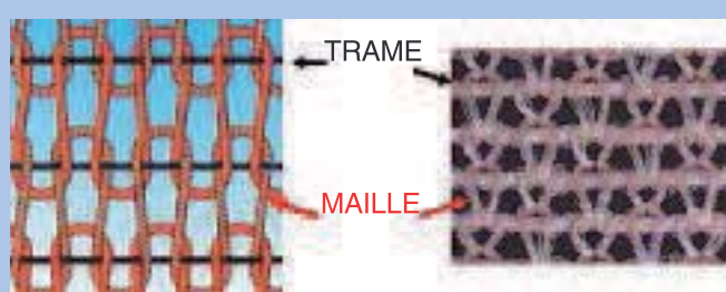
FIGURE 2 : Maille et trame d'un bas de compression.
