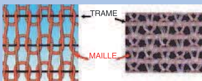
FIGURE 2 : Maille et trame d'un bas de compression.
