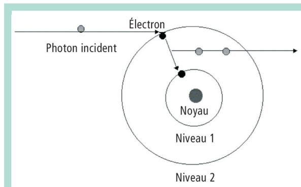
FIGURE 5 : Action du laser sur un atome.
