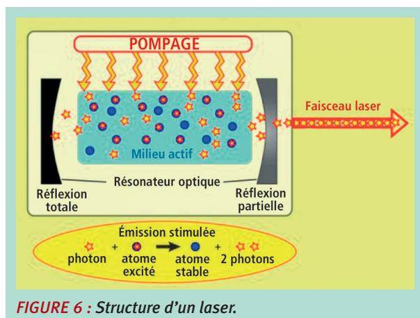
FIGURE 6 : Structure d'un laser.
