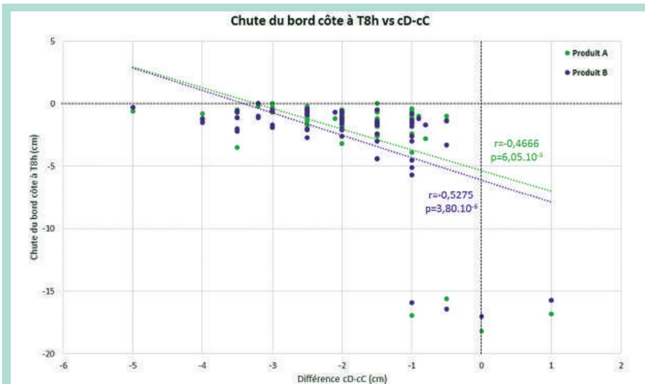
**FIGURE 6 :** Valeurs individuelles de chute du bord-côte en cm entre T0 et T8h en fonction de la différence de circonférence cD (3 cm sous le creux poplité) - cC (au plus fort du mollet) pour les produits A et B.
