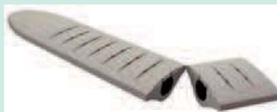
FIGURE 2 : Manchon utilisé pour les mesures
