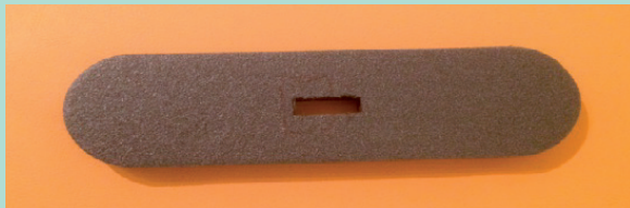
FIGURE 3 : Une fenêtre rectangulaire (30 mm / 10 mm) a été réalisée au sein de la partie rigide du dispositif.
