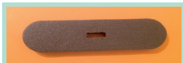
FIGURE 3 : Une fenêtre rectangulaire (30 mm / 10 mm) a été réalisée au sein de la partie rigide du dispositif.
