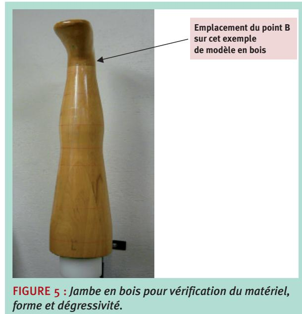
FIGURE 5 : Jambe en bois pour vérification du matériel, forme et dégressivité.
