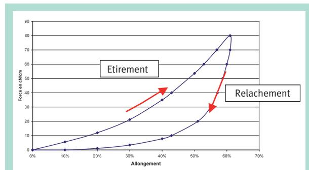
**FIGURE 4 :** Courbe d'hystérésis à partir d'une bande élastique.
