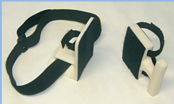
FIGURE 1 : Dispositif porte-sonde échographique ultrasonore.
